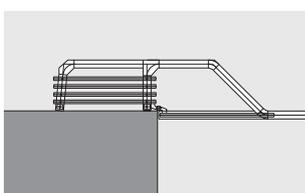
**Aparcamiento tras panel pivotante con eje desplazado**
