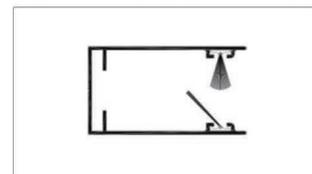
Guía **antiviento** incorporada de serie, protege la tela de golpes de viento, con una sujeción eficiente.
